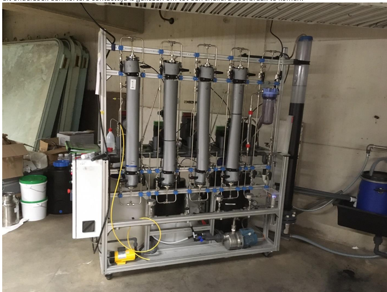
Figuur 3-1: Foto van de Diagnosetool pilot die is gebruikt voor de kolomexperimenten op Kralingen (Evides)
